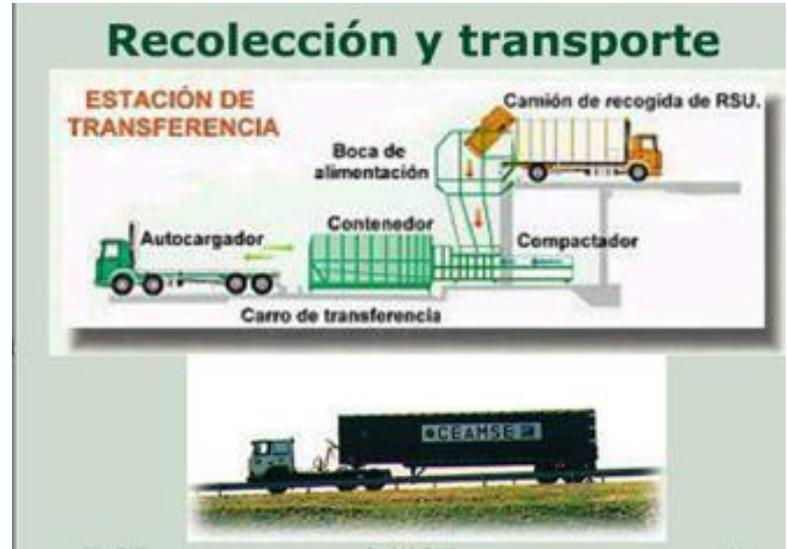
Otro tipo vehículo o camión que se utiliza y que no posee este elemento, es del tipo semi-remolque, que en el relleno es tomado por un equipo o máquina que lo eleva e inclina para que, por gravedad, vierta la carga de residuos en la superficie dispuesta para que luego se la distribuya y compacte en la celda.
