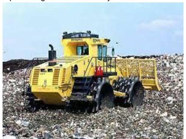
Para operar este tipo de relleno sanitario se requiere del uso de un compactador de residuos sólidos, así como equipo especializado para el movimiento de tierra: tractor de oruga, retroexcavadora, cargador, volquete, entre otros.
