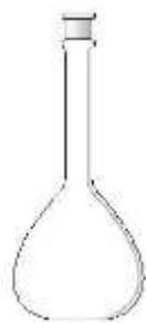
**Matraz Aforado:** está provisto de un cuello largo y una señal de aforo que indica su capacidad. Este recipiente, con un volumen muy preciso, **se utiliza para preparar disoluciones de una concentración dada**. Posee un tapón para homogeneizar la disolución mediante agitación.
