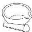
**Mortero:** se usa para la disgregar y/o pulverizar sustancias en el laboratorio, pueden ser de cerámica, vidrio, ágata, etc.
